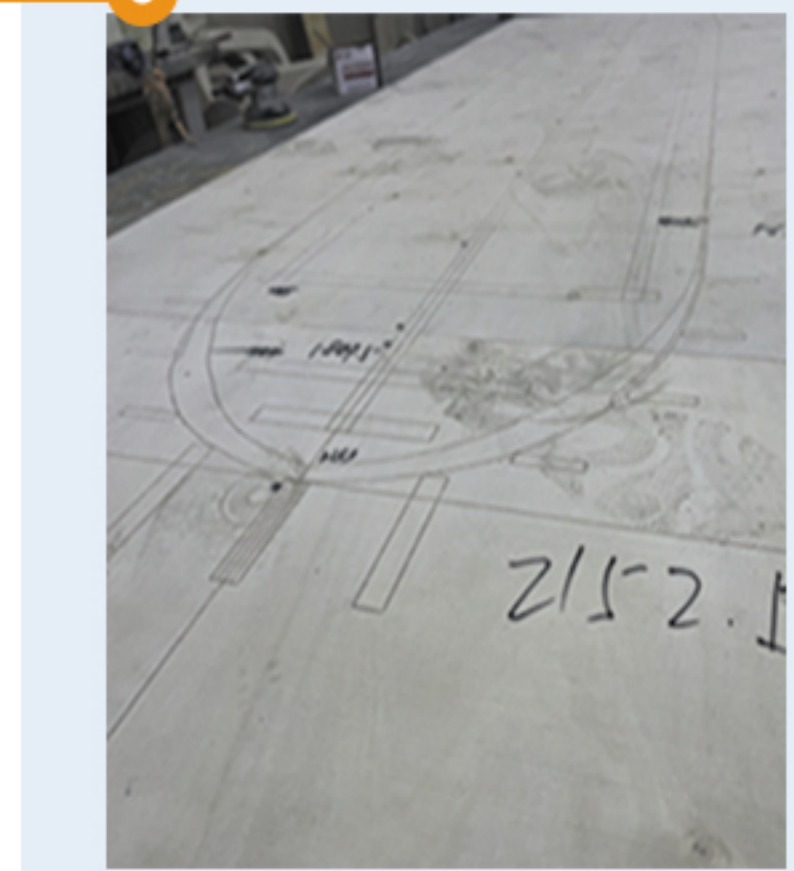
装配底板 CNC木材加工
