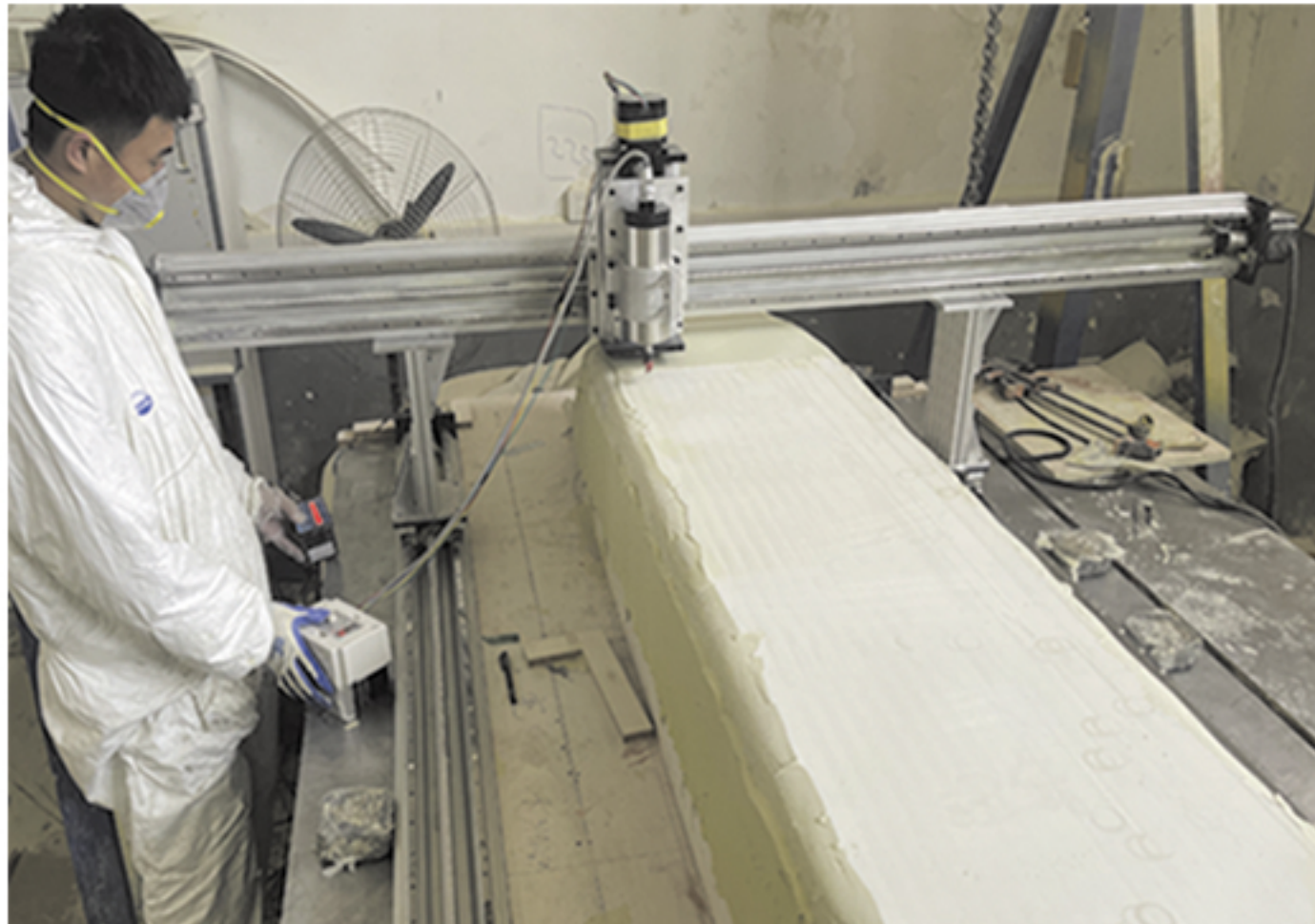
碳纤维-玻璃纤维复合涂层加工技术, 移动式数控加工平台
