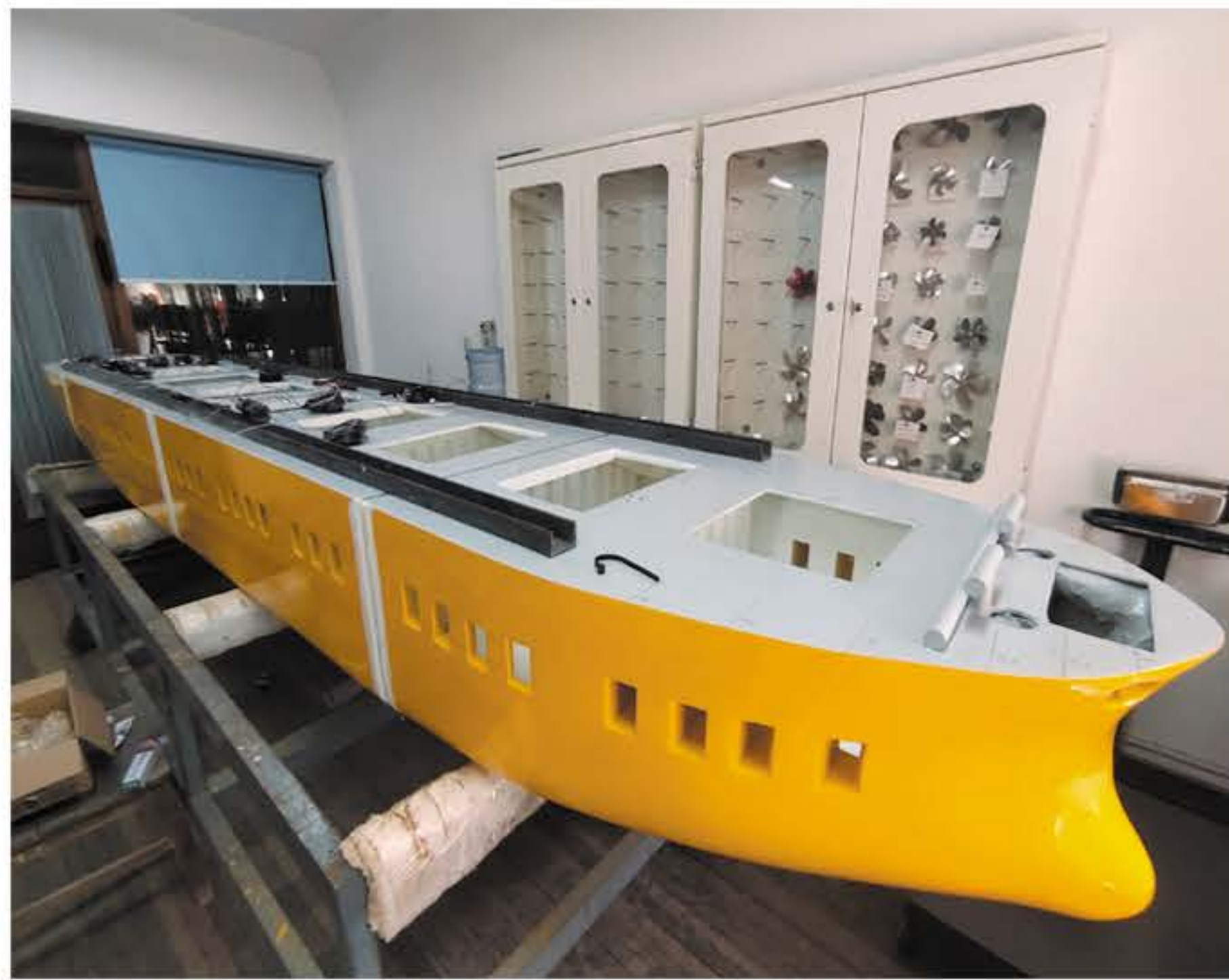
某分段结构试验船模
