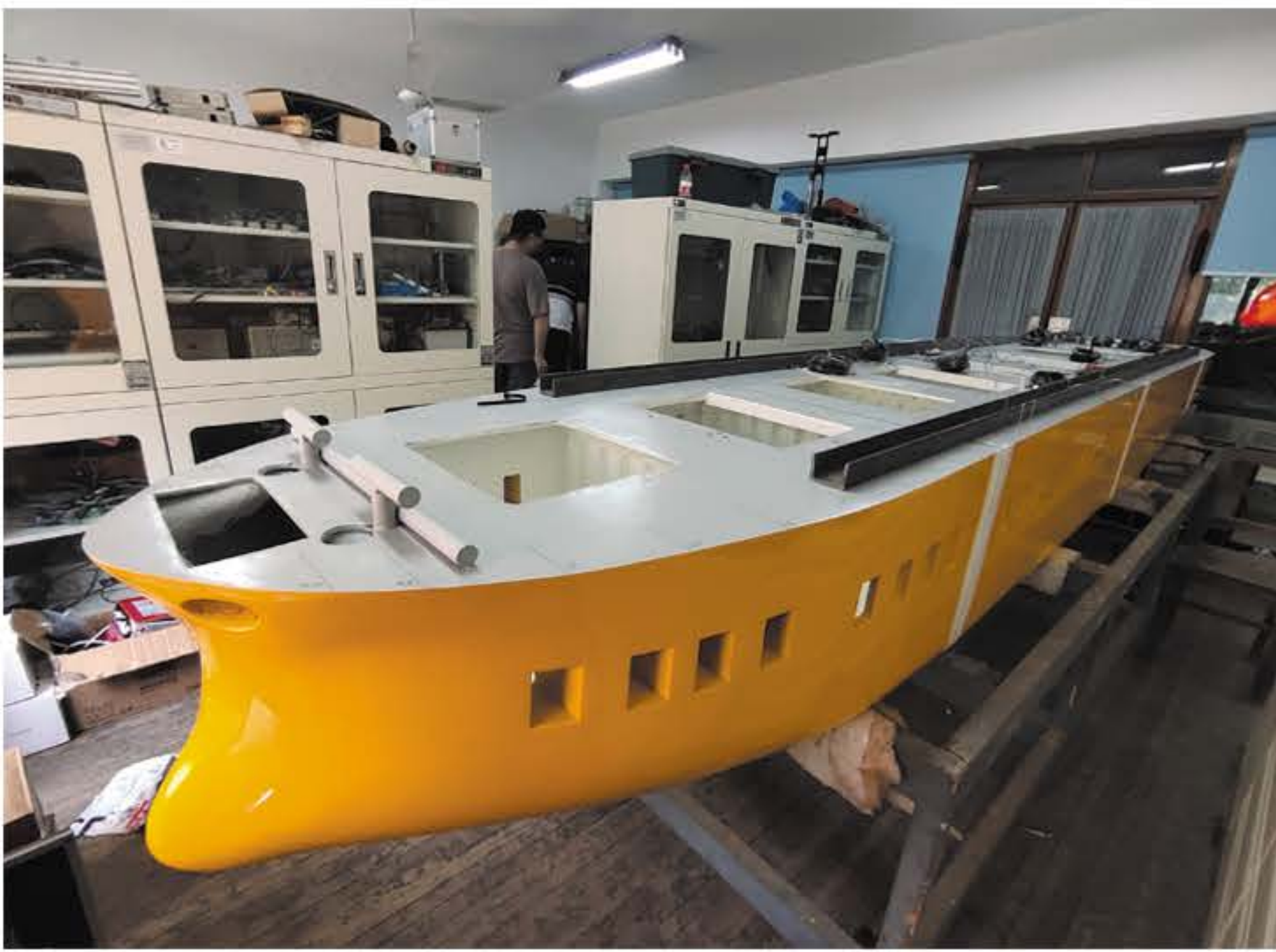
某分段结构试验船模
