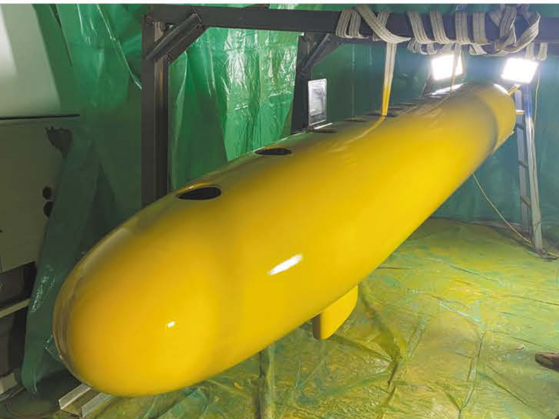
某水下阻力试验模型
